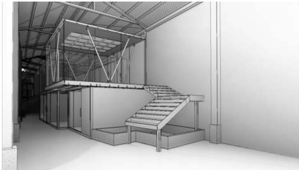
Hình 1.4 Mô hình BIM hiện trạng công trình được lập dựa theo đám mây điểm
